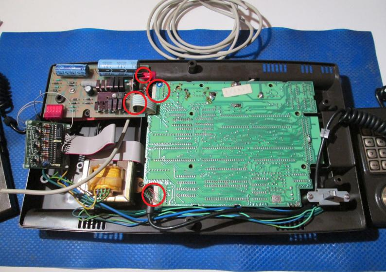
Inserisci il cavo SCART nel foro del connettore RF e posiziona il cavo all'interno della console.
