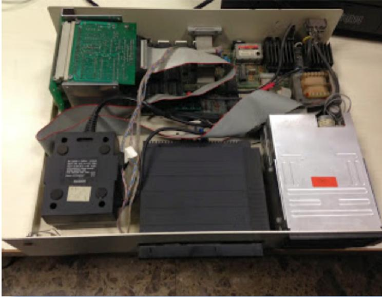
*L'interno dello Spem è fantastico nella sua semplicità: l'alimentatore fissato sottosopra con del bi-adesivo, i microdrive sono stati letteralmente segati da un case originale, la mainboard è posta verso il fondo, inserita in un bus di espansione con la scheda controller ed un po' di ram aggiuntiva.*
