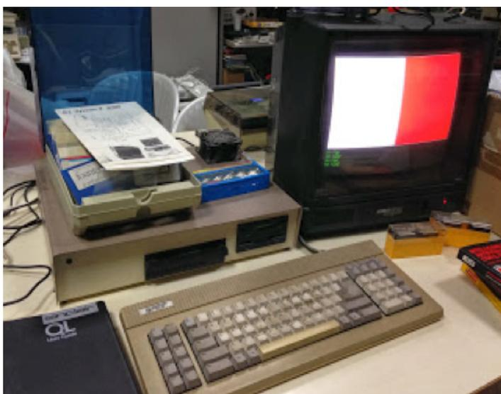
Con grande sorpresa scopriamo che l'esemplare in oggetto è un interessantissimo Spem System2, ossia un Sinclair QL, montato in un case metallico, equipaggiato con controller floppy e due drive da 3"1/2. Una grossa ventola, alimentata a parte, spunta in modo un po' buffo dalla carcassa. A corredo alcune scatole contenente documentazione e qualche libro. Una stampante Epson LX-400 ad aghi completa il tutto.
