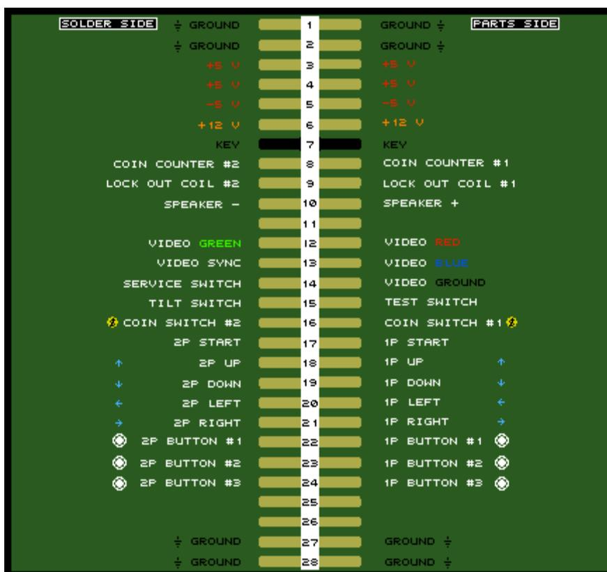
legando i polo del monitor arcade con quelli del connettore VGA maschio (tale connettore è facilmente reperibile in negozi di elettronica). Nella figura che segue è riportato lo schema delle connessioni: ci vuole solo un po' di abilità nelle saldatu-
