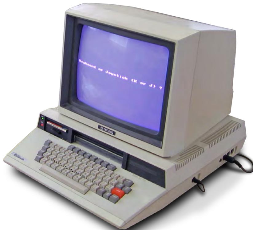
*perdita di una delle due unità floppy (la seconda deve eventualmente essere aggiunta esternamente), pur senza alcun aumento di capacità di memorizzazione. L'alimentatore esterno, scelta peraltro indispensabile visto il nuovo layout "contenuto" dell'unità centrale, è ulteriore indicazione della perdita delle velleità professionali e dell'intento di andare nella direzione home a tutto tondo.*
