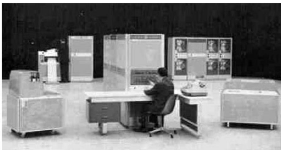
Fig.2 – Un General Electrics GE225, il mainframe su cui venne implementato il sistema DTSS per utilizzare un computer in tempo reale ed elaborazione condivisa attraverso terminali anziché attraverso sistemi di elaborazione batch.
