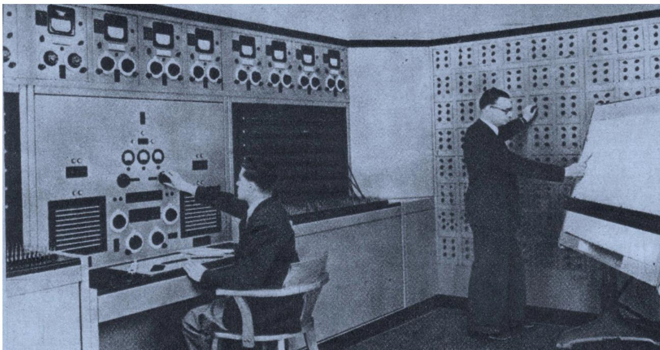
*Parte di una calcolatrice elettrica costruita dalla Thoms-Houston per il calcolo rapido delle variazioni nelle caratteristiche delle reti elettriche, ma che serve anche per la risoluzione di qualsiasi problema di matematica superiore i cui termini possono essere espressi in equivalenti elettronici.*
