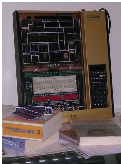
Non solo Olivetti è stata l'azienda italiana che ha partecipato alla scrittura della storia della micro informatica. Anche SGS con i numerosi componenti con le schede industriali semi-assemblate e soprattutto con questo sistema didattico basato sulla CPU Z80.
