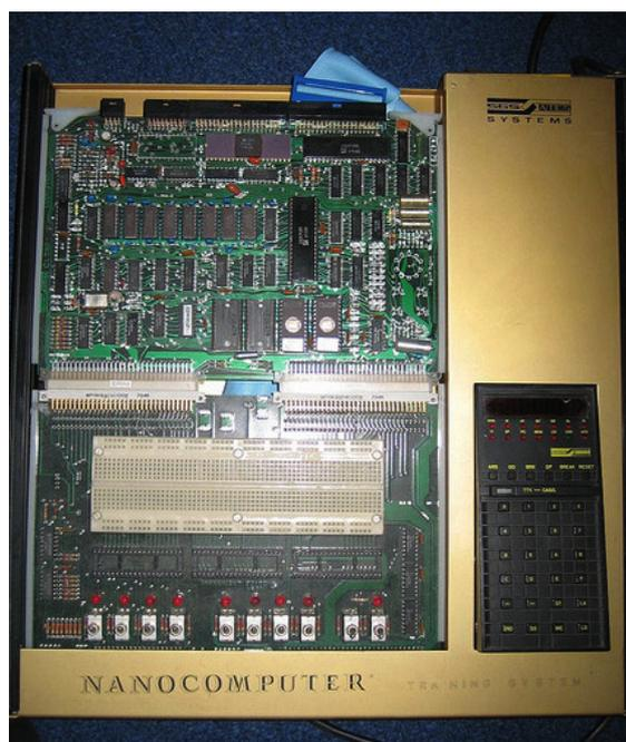
adeguato a stare su un banco di lavoro anche non troppo grande di un laboratorio. Le dimensioni sono 36 cm di larghezza per 40 cm di profondità e 5 cm di spessore. La superficie superiore è occupata per il 90% dagli alloggiamenti per le due schede: la CPU, fissa, e la scheda di espansione (normalmente con la breadboard) per gli esperimenti.
